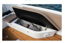
Dans sa version de base, le 858 Fantom Air est plutôt du genre spartiate. Le tiroir réfrigérant, les biminis, la douche de poupe et d'autres options doivent être commandés séparément. À noter la qualité de construction et plusieurs détails bien pensés. Par exemple: les coussins d'assise relevables afin d'ouvrir les espaces de rangement sont solidement fixés sur des charnières.
