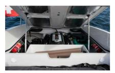
Le Frauscher 858 Fantom Air est disponible avec trois motorisations différentes et une plage de puissance allant de 300 cv à 430 cv. Le bateau de test était équipé d'un moteur V8 MerCruiser de 350 cv – un choix parfaitement approprié. À noter ici l'installation soignée et le compartiment moteur bien aménagé – avec y compris un compartiment pour les coussins de proue.
